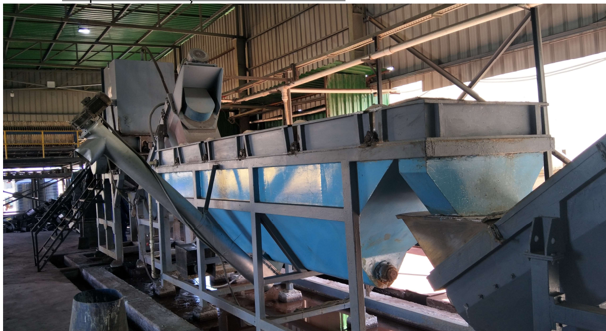
Foto 6 – Máquina de trituração do material Plástico
