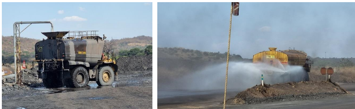
Figura 6-9 – supressão de poeiras, por irrigação, dos acessos mineiros
